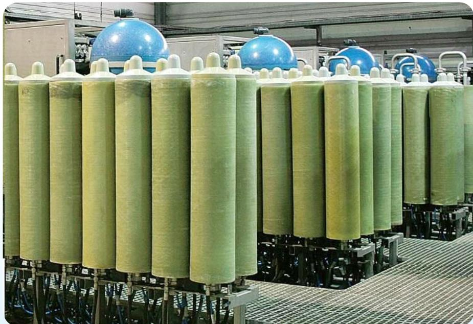
碟管式反渗透是反渗透的一种形式，是专门用来处理高浓度污水的膜组件，DT组件操作压力具有75bar,150bar,200bar三个等级可选，处理对象涉及到垃圾填埋场渗滤液、垃圾堆肥场渗滤液处理。针对这一特性，我公司研发部自行研制开发了Winder DTRO（碟管式反渗透）玻璃钢耐压外壳即DTRO外部组件。
